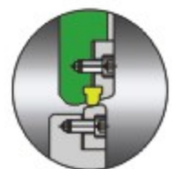
6. 橡胶密封(可更换阀座)
